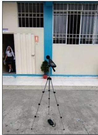
*Figura 11. Monitoreo de la estación zona 13 con sonómetro clase 2*
