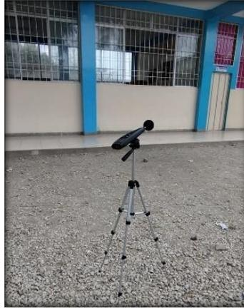
*Figura 10. Monitoreo de la estación zona 9 con sonómetro clase 2*
