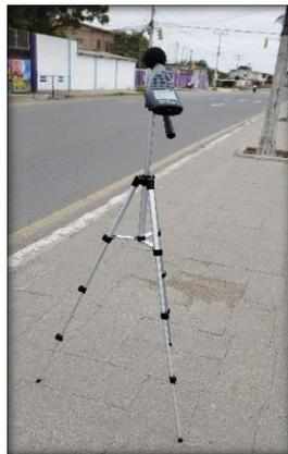
*Figura 30. Medición con sonómetro en Estación 4, Av. Francisco Pizarro, horario matutino*
