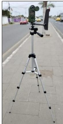
*Figura 36. Medición con anemómetro en Estación 6, Av. Francisco Pizarro, horario vespertino*
