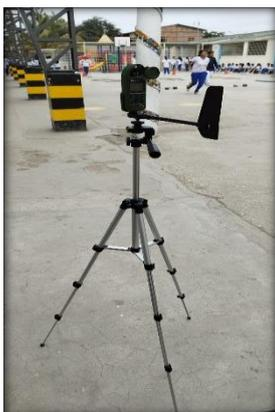
*Figura 27. Medición con anemómetro en Estación 12, Bloque 3, horario vespertino*
