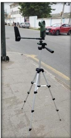
*Figura 25. Medición con anemómetro en Estación 6, Av. Francisco Pizarro, horario vespertino*
