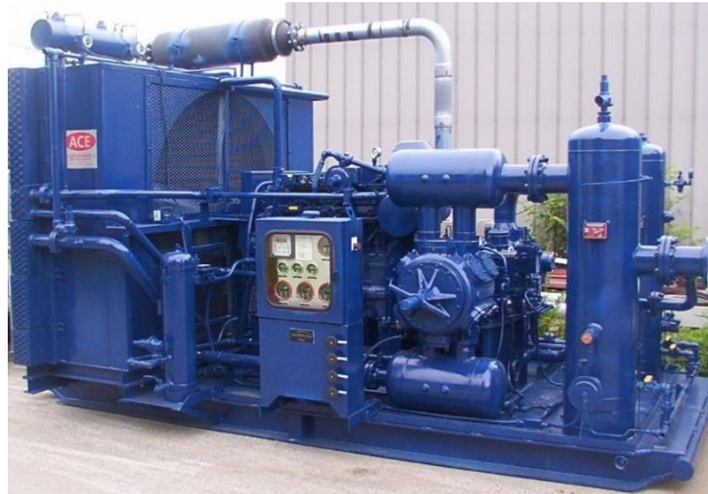
Compresor de gas
