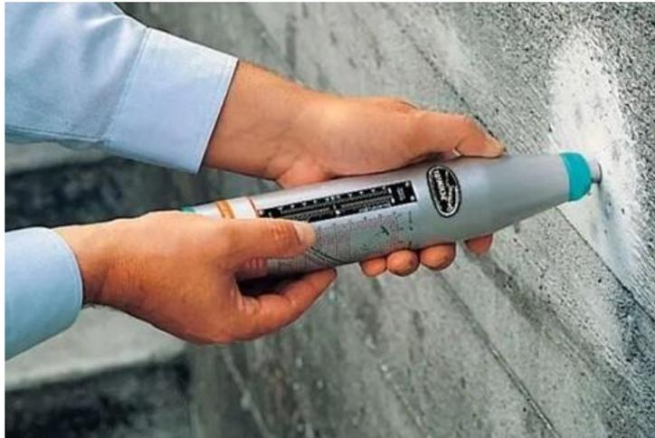
*Nota:* Ilustración tomada Ensayo de Esclerometría (CONSTRUNEIC, 2024).
