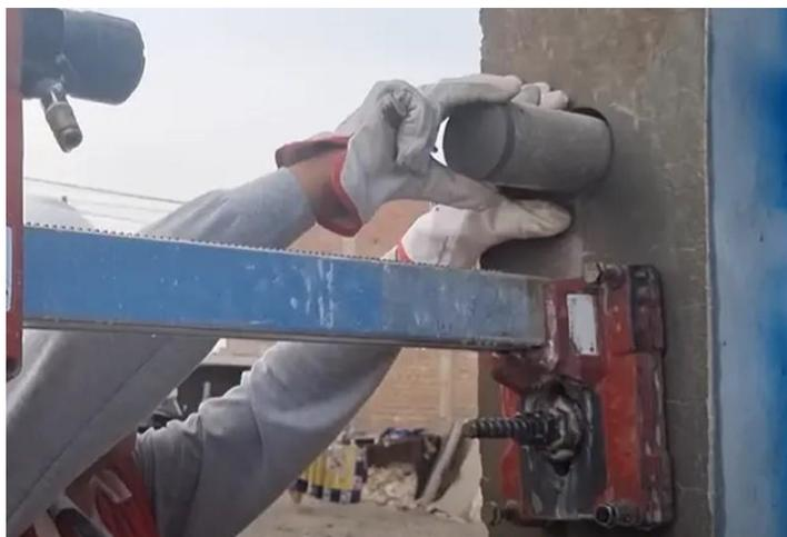
*Nota:* Ilustración tomada Ensayo de Diamantina (CONSTRUNEIC, 2024).
