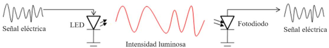
Figura 1. 10: Modulación de intensidad y detección directa en los sistemas ópticos
