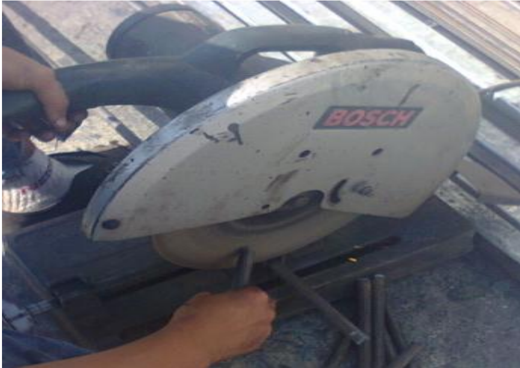
MÁQUINA CORTADORA DE VARILLAS
