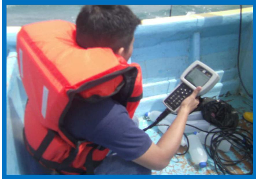
Foto 5. Empleo del YSI para determinar parámetros ambientales (temperatura, salinidad, oxígeno disuelto y pH). Fuente: Salinas L. 2014
