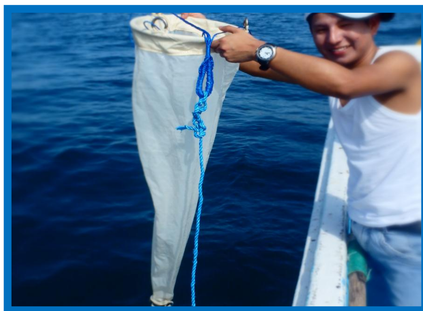
Foto 2. Red estándar cónica simple. Fuente: Salinas L. 2014
