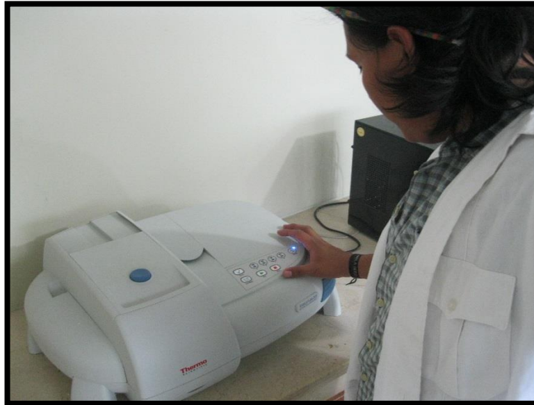
Foto 19. Espectrofotómetro para determinar Nitrato y Fosfato
