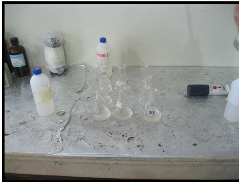
Foto 18. Fiolas con muestra filtrada para determinación de Fosfato y Nitrato
