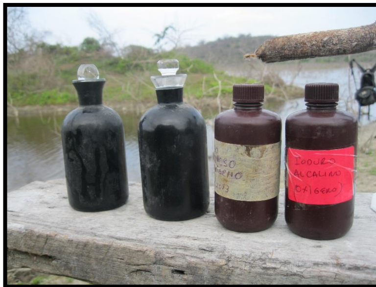
Foto 10. Soluciones fijadoras de oxígeno y botellas para DBO.
