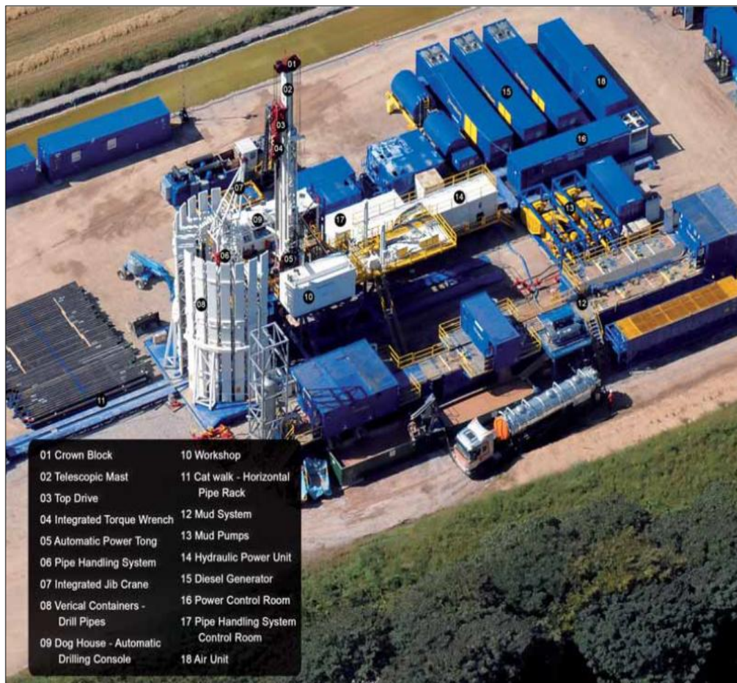
GRÁFICO N° 5.3: PARTES PRINCIPALES DEL TALADRO AUTOMÁTICO
