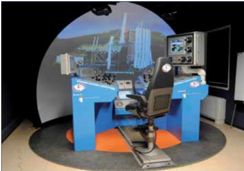
Consola de los simuladores de perforación
