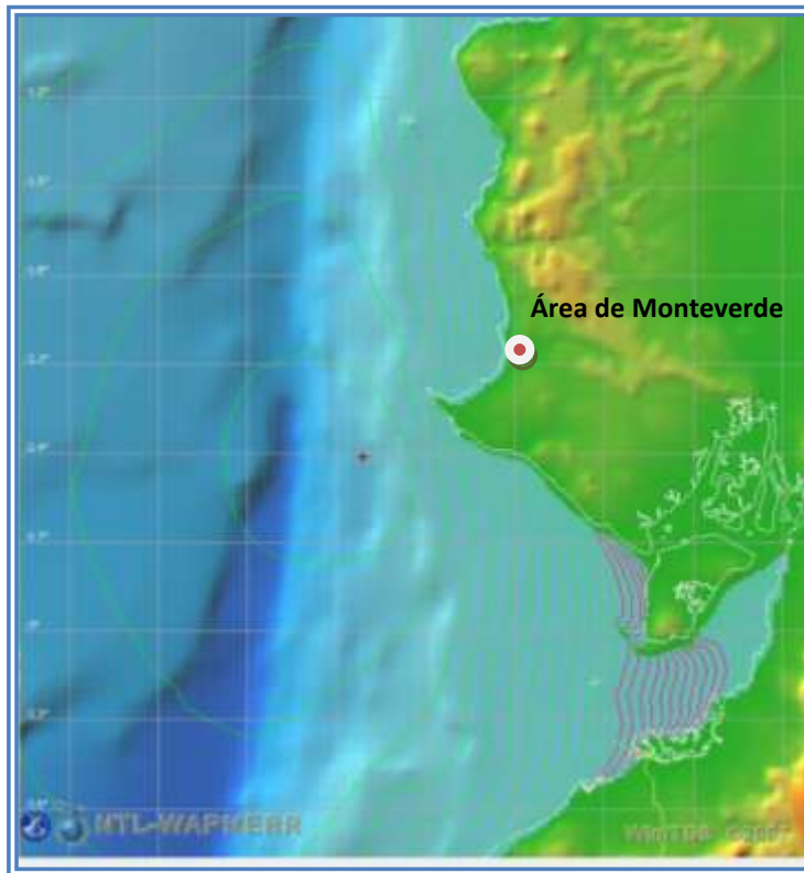
Figura 25: Modelamiento de tsunamis en las costas del Océano Pacífico hasta la zona de estudio. (Elaborado por Jc Lema & E. Baque 2.012). Fuente: CIGEO UPSE.
