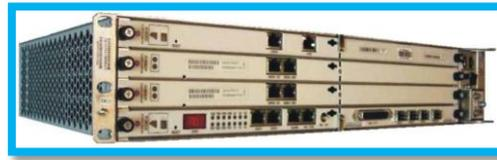
Figura 3.3 Vista exterior del eNodeB 9326 D2U V2
