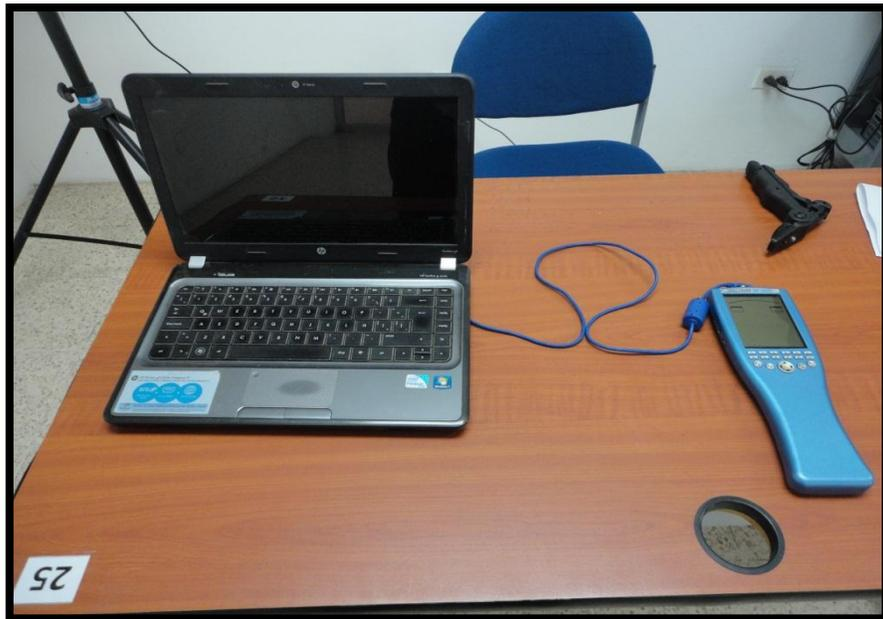
**FIGURA 3. 12** Conexión entre PC y SPECTRAN NF-5035 a través de cable USB
