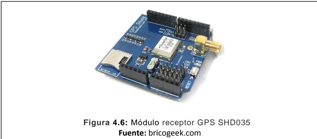
Este dispositivo permite obtener posición, tiempo y velocidad; la posición geográfica se obtiene con una tolerancia de  $\pm 15$  m. El GPS envía los datos de posicionamiento a través del protocolo NMEA 0183 ver 2.3 el cual es capaz de enviar 8 diferentes tramas con información específica (Figura 4.6).
