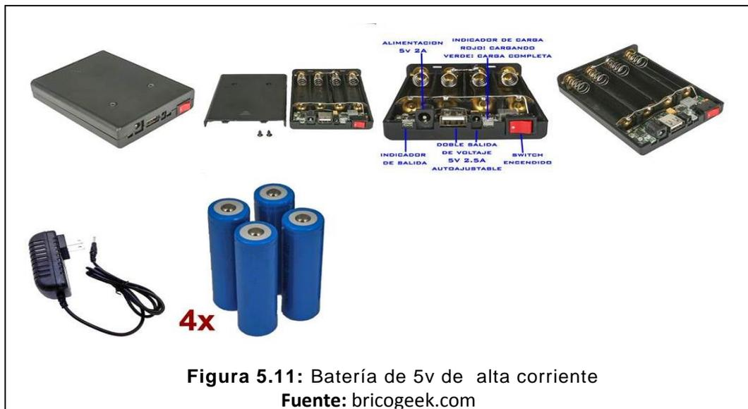
La figura 5.11 muestra la batería que se utilizó, además de ofrecer alta corriente se acoplaba por el tamaño que ocupaba, pues no debía ser muy grande ya que después no entraba en la carcasa de nuestro sumergible, las baterías son LIPO, las mismas que también utilizamos con los motores Brushless.
