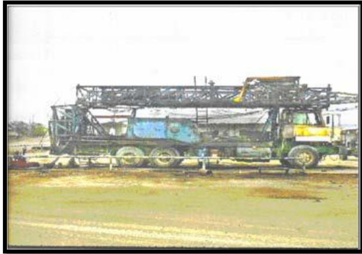
Fig.1.9.- Sistema levantamiento Artificial por Swab o Pistoneo.
