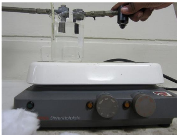
Anexo 12. El arreglo de los electrodos en la celda electrolítica previo a ser conectado al potenciostato. Fuente: Autores.
