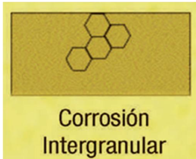
Figura 3. Corrosión intergranular. Fuente: Tamsa Tenaris Group.
