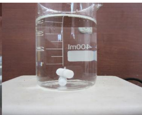
Figura 21. Agitador magnético dentro de la celda. Fuente: Autores.
