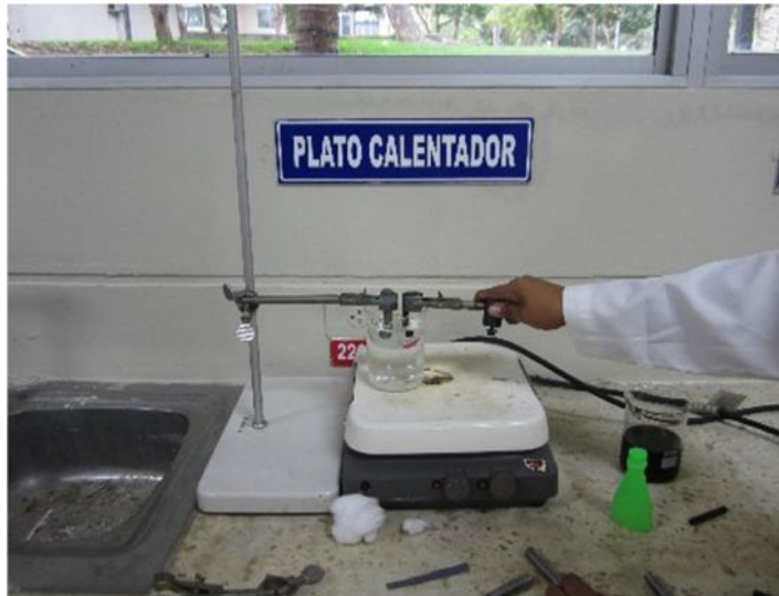
Figura 24. Arreglo de los electrodos en la celda electrolítica antes de ser conectados al potenciostato. Fuente: Autores.
