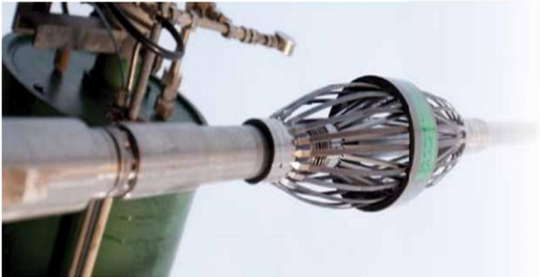
Figura 7. Herramienta de inducción electromagnética. Fuente: Schlumberger.
