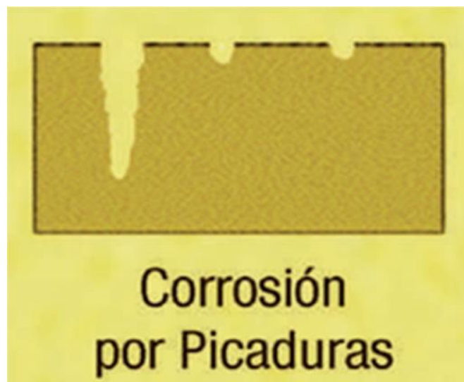
Figura 2. Corrosión por picaduras. Fuente: Tamsa Tenaris Group.
