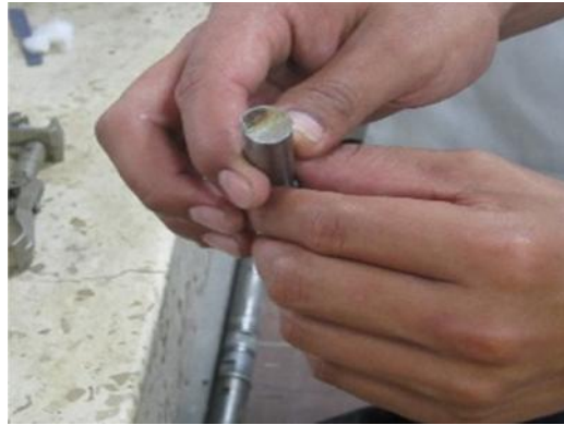
Figura 26. Parte inferior del acero corroída. Fuente: Autores.
