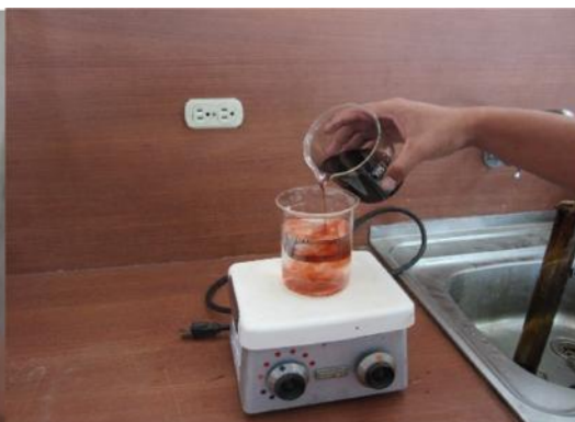
Figura 23. Inhibidor de corrosión vertido en la solución acuosa acida. Fuente: Autores.
