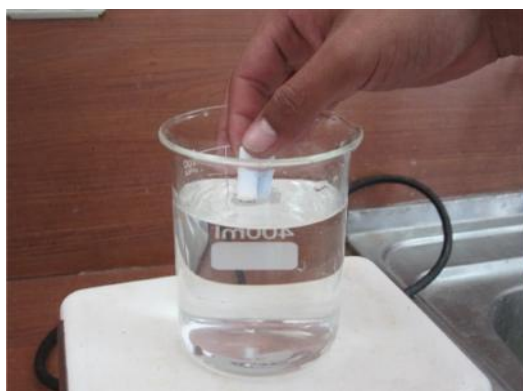
Figura 20. Instante en que agitador magnético es sumergido en la celda electroquímica. Fuente: Autores.
