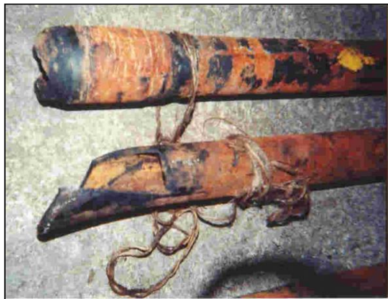
Anexo 2. Tuberías de revestimiento corroídas después de varios años de uso. Fuente: David Hernández. Corrosión en tuberías.
