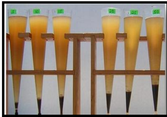
Figura 2 Conos Imhoff para medir biofloc como la concentración de los sólidos que se depositan después de 10 a 20 minutos.
