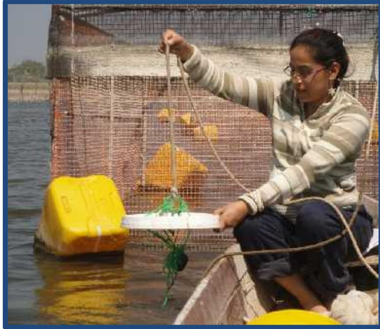
**Foto 3.** Medición de turbidez mediante el disco de Secchi.
