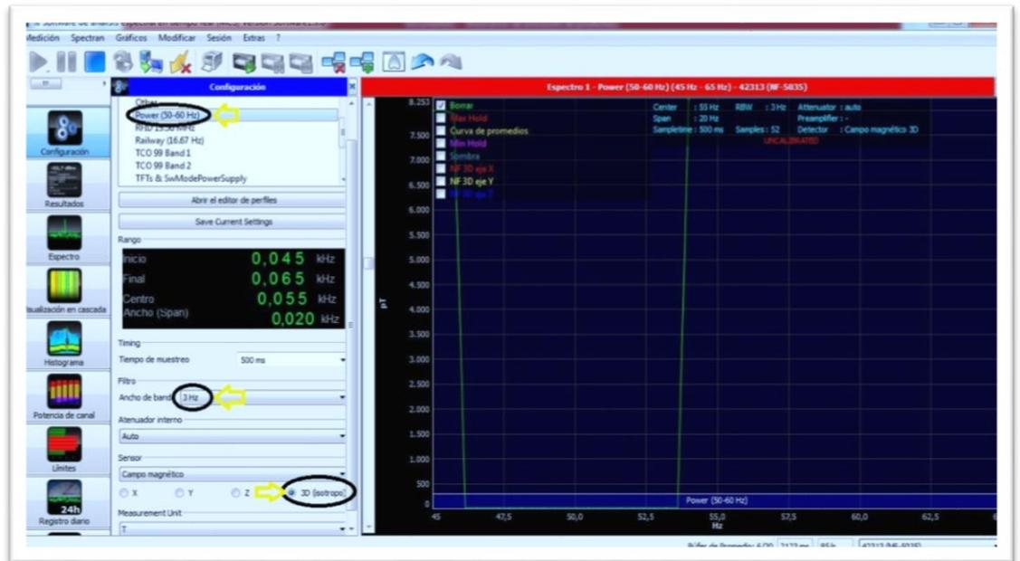
**Ilustración N° 18** verificación del ancho de banda, campo magnético y frecuencias a utilizar.
