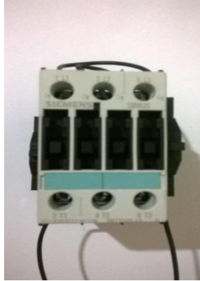
Figura N° 18 Contactor de bomba monofásico
