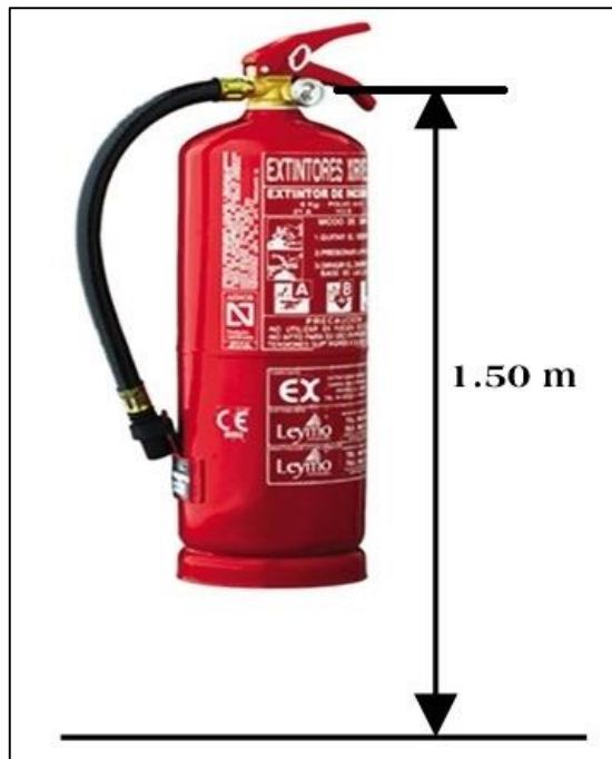
Gráfico N° 16: Medidas de Instalación de Extintor
