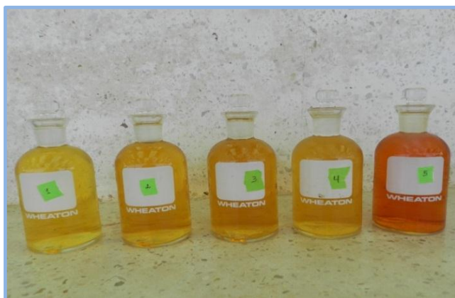
Figura 9. Muestras de agua en botellas de DBO agitadas con las soluciones 1 y 2.
