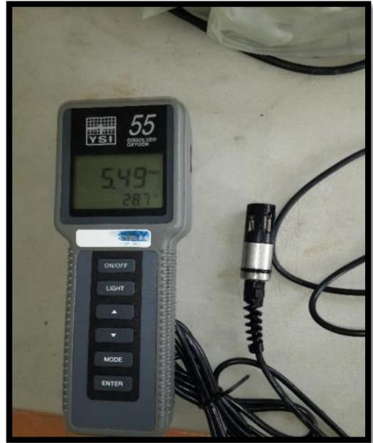
**Foto # 14. Medición de temperatura y oxígeno disuelto en los tanques de muestreo, con el equipo YSI (55 Dissolved oxygen).**
