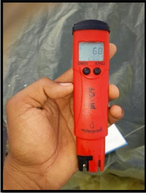
**Foto # 15. Medición de pH en los tanques de muestreo, con u pH-metro (pHep by HANNA).**
