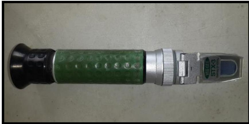
**Foto # 16. Medición de salinidad en los tanques de muestreo, con refractómetro (VEE GEE STX-3).**
