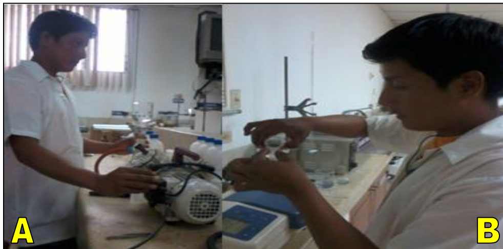
Figura 18. Análisis de nutrientes del agua. A) Filtrado del agua y B) Proceso de Fluorometría.
