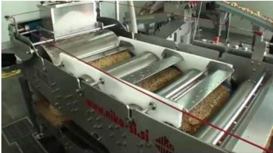
**FIGURA 3 DESFIBRADORA DE CASCARA**
