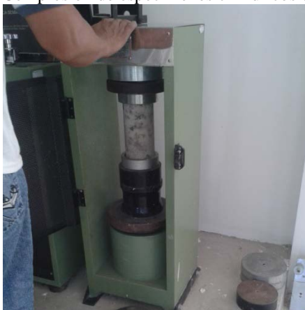
Figura 11. Compresión de especímenes cilíndricos de concreto.
