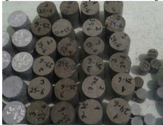
Figura 10. Curado de los especímenes de hormigón.
