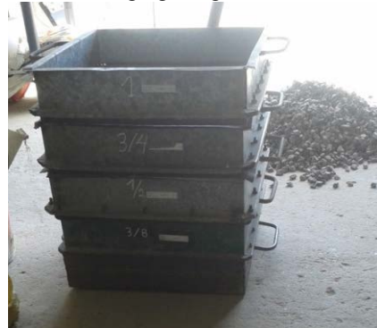
Figura 3. Tamices metálicos para agregado grueso.
