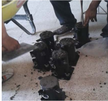
Figura 9. Varillado de cada capa de hormigón.
