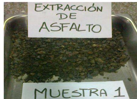
Muestra después después del ensayo.
