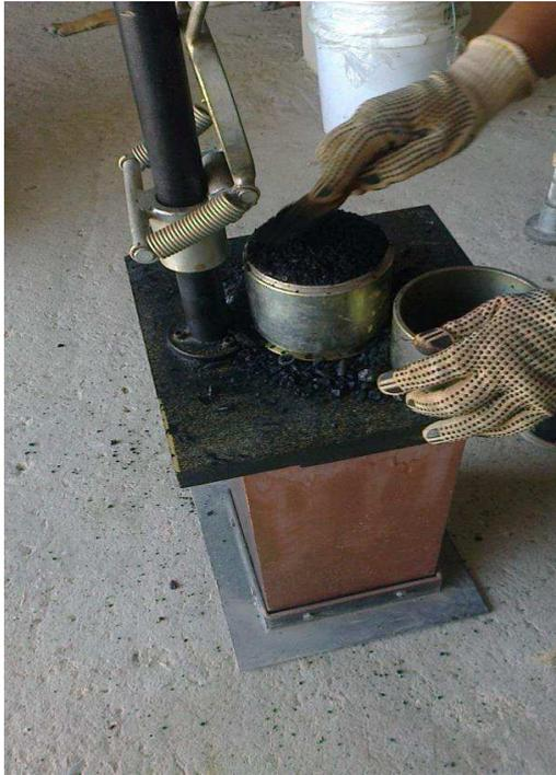
Colocación de la mezcla en los moldes.
