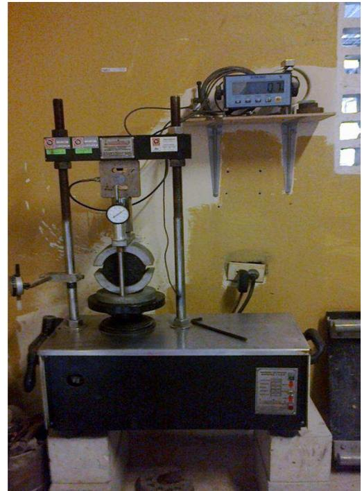
Máquina de Rotura Marshall.
