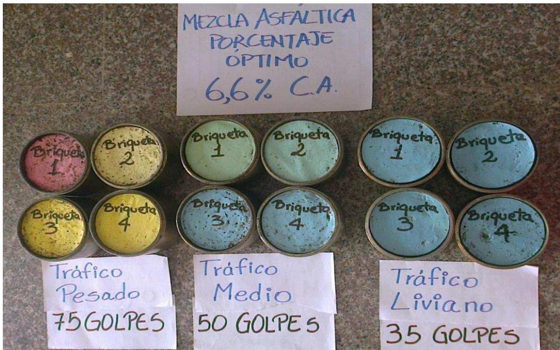
Briquetas elaboradas para distintos tipos de tráficos.
