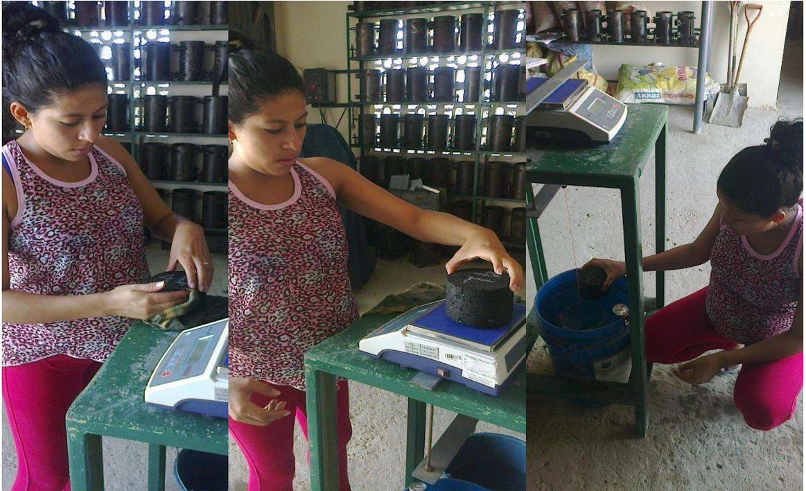
Determinación de Densidad o Gravedad Específica Bulk de las Briquetas.
