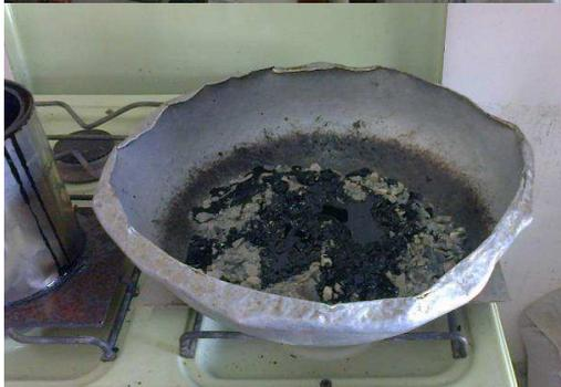
Mezclas de Agregados y Cemento Asfáltico
