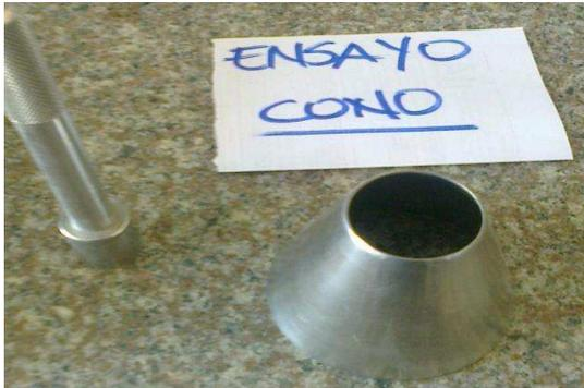
Equipo para determinar condición S.S.S.
