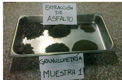
Ensayo granulométrico de la extracción.
