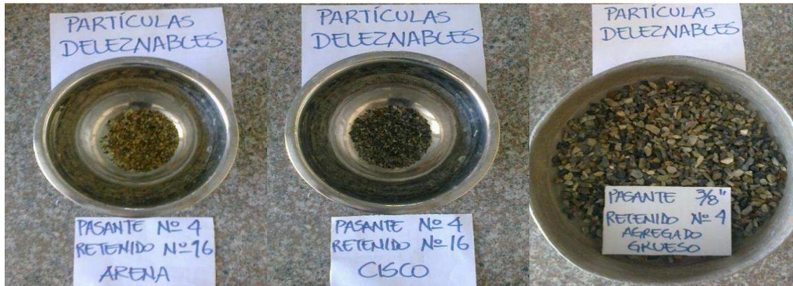
Agregados tamizados para la realización del ensayo.
