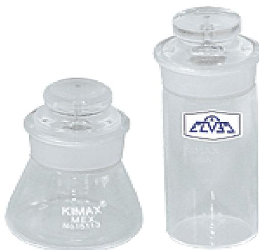
**Figura 3-1 Equipo para determinar Gravedad Específica.**
