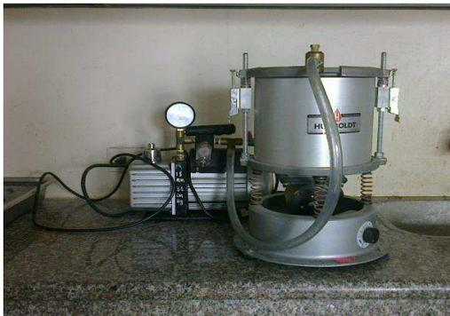
Equipo Rice para el ensayo.
