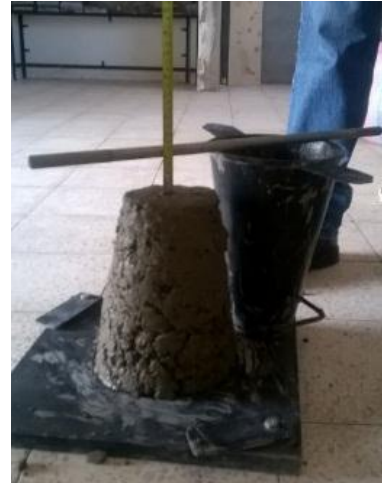
Figura 3. 12 Medición del asentamiento. Fuente: V. Hidalgo, A. Rodríguez.
