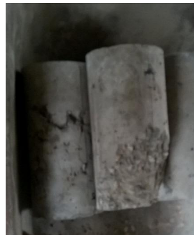
Figura 4. 26 Tipo de fractura en probeta Fuente: V. Hidalgo, A. Rodríguez
