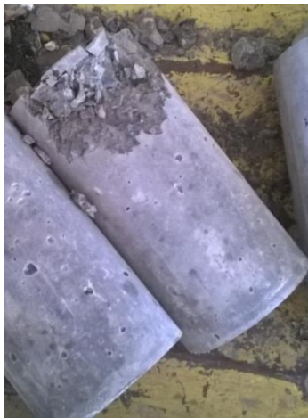
Figura 4. 26 Tipo de fractura en probeta Fuente: V. Hidalgo, A. Rodríguez
