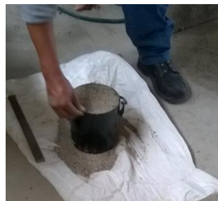
Figura 3. 2 Colocación del material. Fuente: V. Hidalgo, A. Rodríguez.
