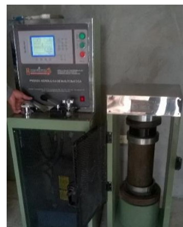
Figura 3. 13 Rotura de cilindro a compresión. Fuente: V. Hidalgo, A. Rodríguez.
