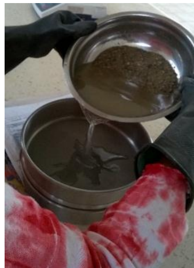
Figura 3. 8 Decantado de partículas Fuente: V. Hidalgo, A. Rodríguez.
