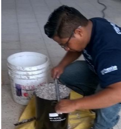
Figura 3. 3 Compactación. Fuente: V. Hidalgo, A. Rodríguez.
