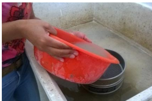
Figura 3. 5 Decantación de partículas. Fuente: V. Hidalgo, A. Rodríguez
