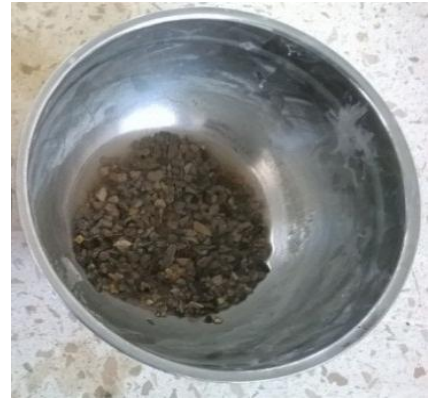
Figura 3. 6 Partículas en remojo con agua destilada Fuente: V. Hidalgo, A. Rodríguez
