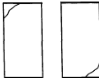
Figura 4. 27 Tipo 5 Fracturas a los lados, en el extremo superior o en fondo Fuente: Norma INEN NTE 1573.
