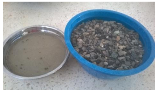
Figura 3. 4 Muestra sumergida en agua. Fuente: V. Hidalgo, A. Rodríguez
