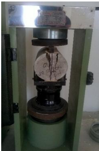
Figura 3. 14 Rotura de cilindro a tracción. Fuente: V. Hidalgo, A. Rodríguez.
