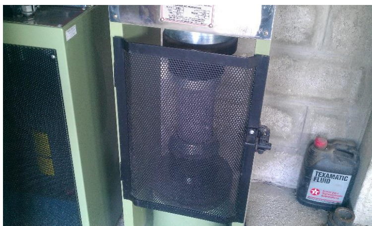
Ilustración 3.12: Ensayo de un cilindro en la máquina de compresión.
