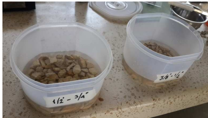
Ilustración 8.11: Muestras sumergidas en el sulfato de magnesio.
