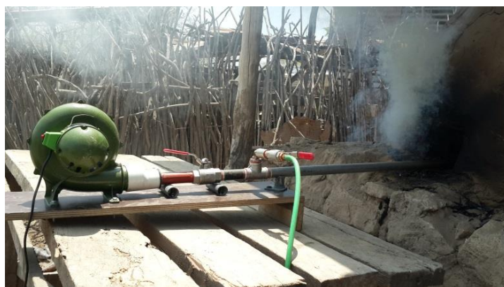
Ilustración 3.6: Quemador diseñado para la combustión del material.
