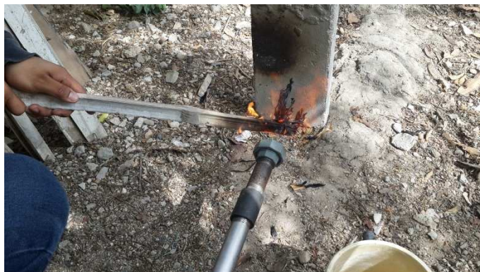
Ilustración 8.3: Ejecución de pruebas al quemador, Incineración de material de prueba.
