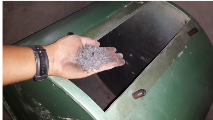
Ilustración 3.9: Ceniza en el equipo de abrasión de los ángeles.
