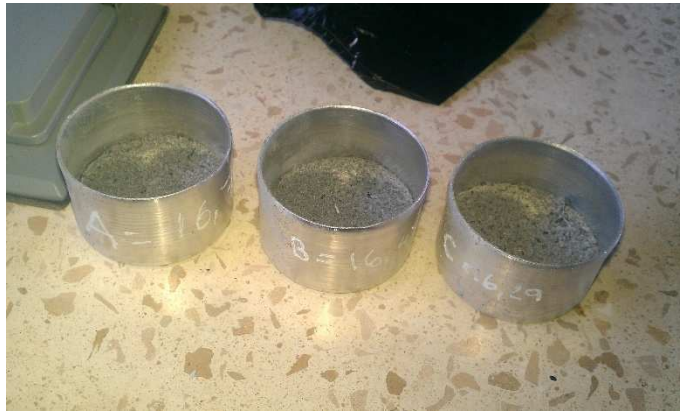
Ilustración 8.12: Pesado de la puzolana artificial para ser ensayada.
