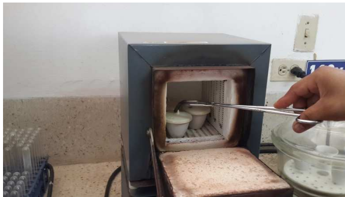
Ilustración 8.13: Colocación de las muestras a ensayar dentro del horno.
