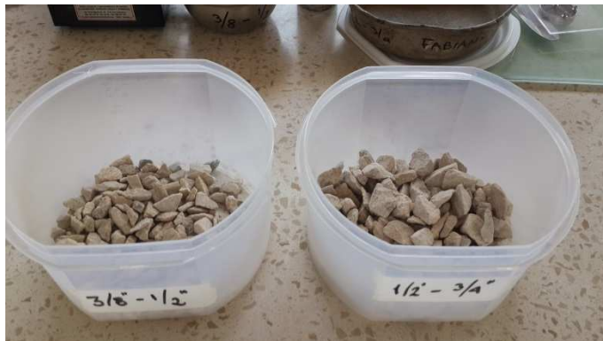
Ilustración 8.9: Agregado grueso tamizado para el ensayo de desgaste por sulfatos.
