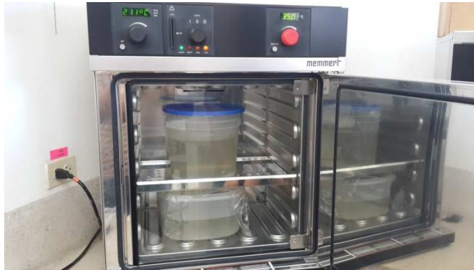
Ilustración 8.7: Colocación de la sustancia preparada a temperatura constante.
