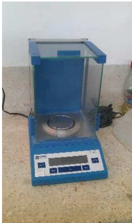
Ilustración 8.16: Balanza con precisión de 0.0001 gr para determinar la pérdida de masa.
