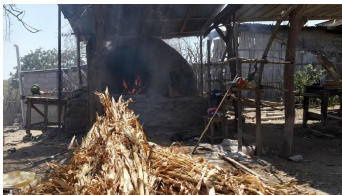
Ilustración 3.4: Horno artesanal usado para el calcinamiento de las plantas de maíz.
