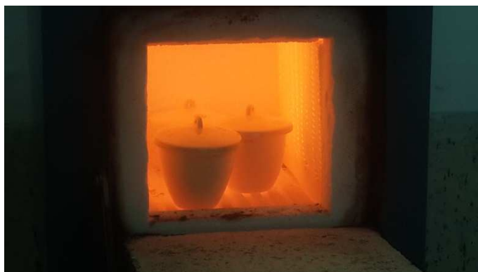
Ilustración 8.14: Crisoles con muestras de puzolana dentro del horno a 1000 °C.
