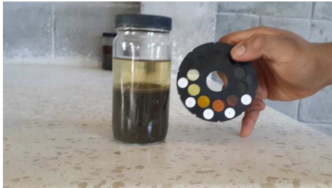
Ilustración 8.18: Determinación del color de la sustancia según el colorímetro.
