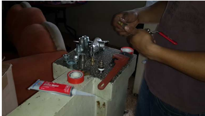
Ilustración 8.1: Ensamblado de piezas para quemador, válvulas y uniones.
