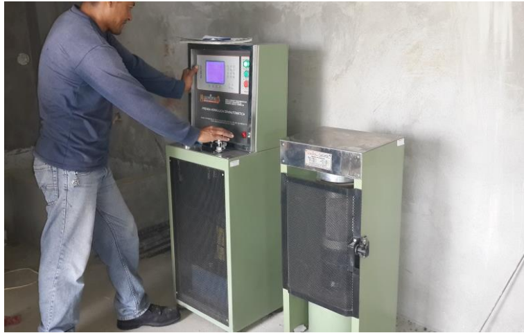
Ilustración 3.13: Probeta cilíndrica en la prensa hidraulica para ser ensayada.
