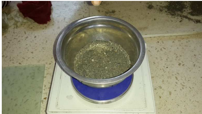
Ilustración 8.17: 450 g de arena necesaria para el ensayo de impurezas orgánicas
