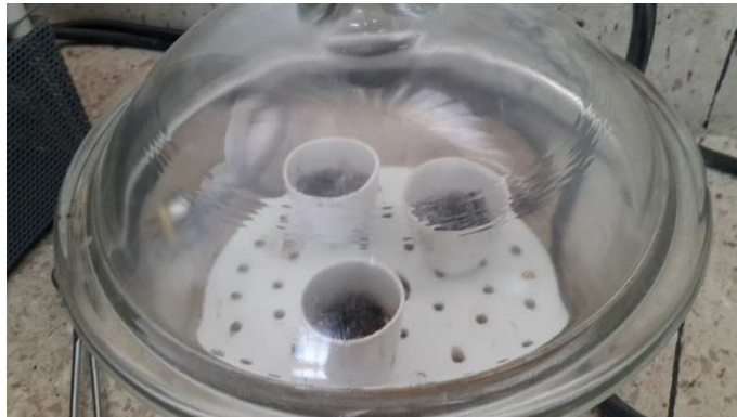
Ilustración 8.15: Enfriamiento de las muestras ensayadas a tres temperaturas.
