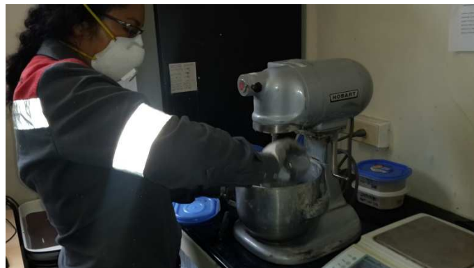
Ilustración 8.6: Mezclado de los diferentes materiales en amasadora de morteros
