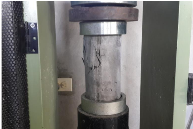
Ilustración 3.14: Probeta cilíndrica ensayada a los 28 días de edad.
