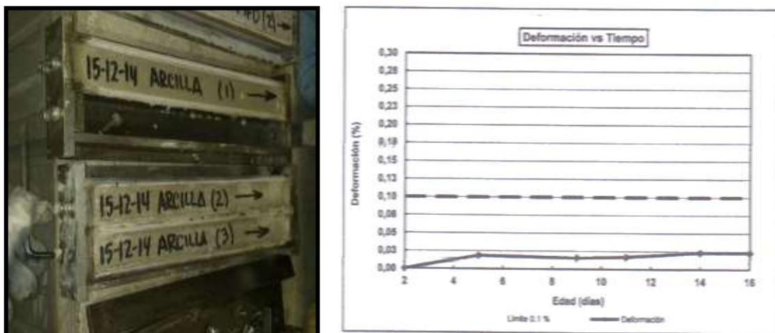
Figura 23. Barras de mortero- Gráfica Reacción Álcali-Sílice Fuente: Centro Técnico del Hormigón (Holcim)
