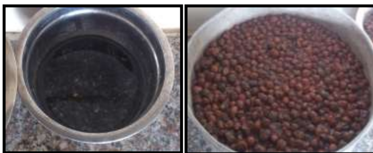
Figura 5. Saturación de la muestra de agregado fino y grueso en agua destilada Fuente: D. Yagual – D. Villacís
