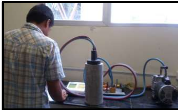
Figura 21. Ensayo de permeabilidad al aire en hormigón
