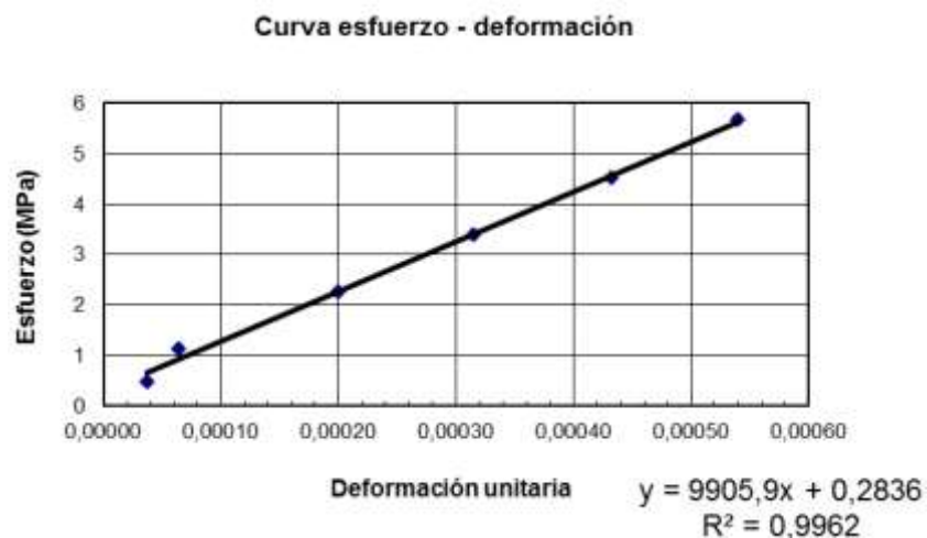
Figura 39. Curva esfuerzo – deformación de Hormigón liviano de alto desempeño con arcilla expandida y cemento HE.
