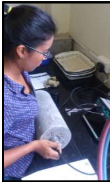
Figura 22. Determinación de la velocidad de pulso ultrasónico a través del hormigón Fuente: D. Yagual – D. Villacís
