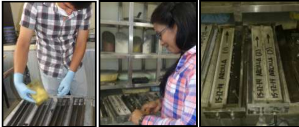
Figura 18. Álcali – agregado (método barras de mortero) Fuente: D. Yagual – D. Villacís
