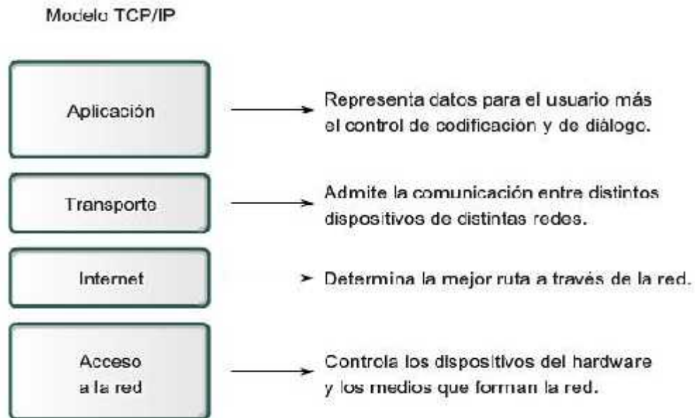
Figura 2.9 Capas del Modelo TCP/IP
