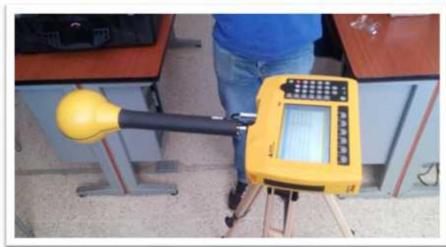
**Ilustración N° 13** Medición del ambiente electromagnético, equipo SRM-3006 NARDA.
