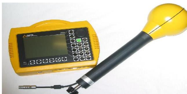
*Figura 24. Equipo de medición de radiación.*
