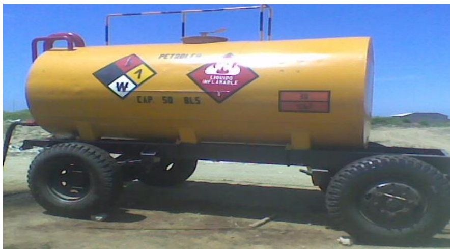
Fig.1.9.C. Tanque de almacenamiento móvil
