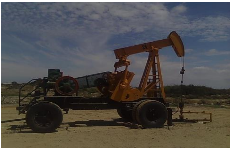
Fig. 1.5.3 Sistema de levantamiento Swab o pistoneo
