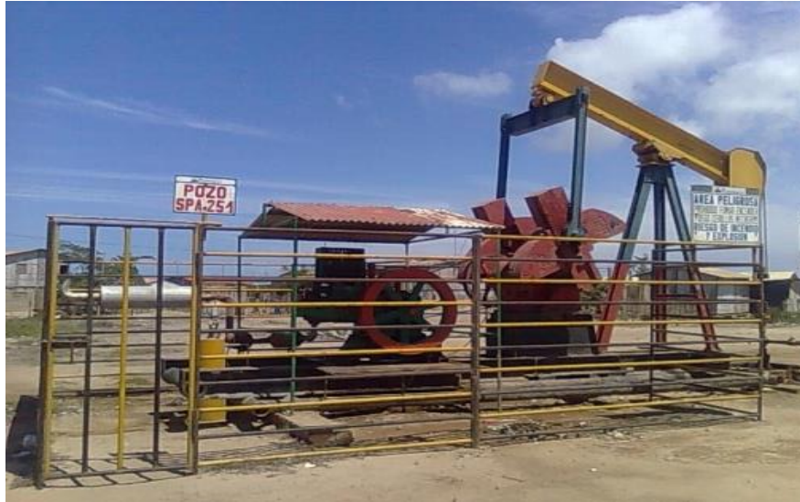
Fig. 1.5.1 Sistema de levantamiento artificial: Bombeo mecánico
