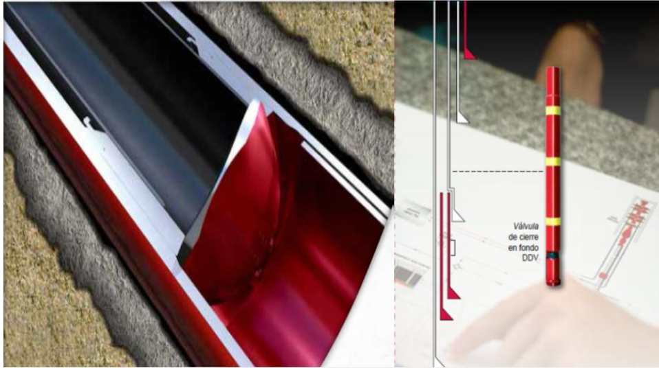
Figura 4.1.- Cuando se debe realizar un viaje, el ensamble de fondo (BHA) se ubica sobre el sistema DDV, el cual se cierra posteriormente desde la unidad de control en superficie. Se libera la presión sobre el sistema DDV y se monitorea el pozo para confirmar que haya aislamiento. Se retira el BHA sin presión en la superficie y a velocidades convencionales.
