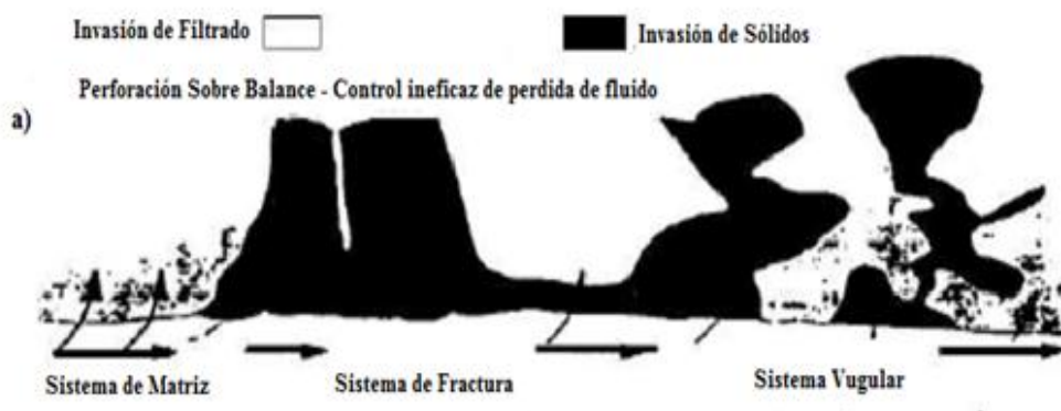
Figura 2.2.- Representación Esquemática de la Pérdida de Líquidos y Sólidos en operaciones Bajo Balance – Sobre Balance. Fuente: Bennion D.B., 2002
