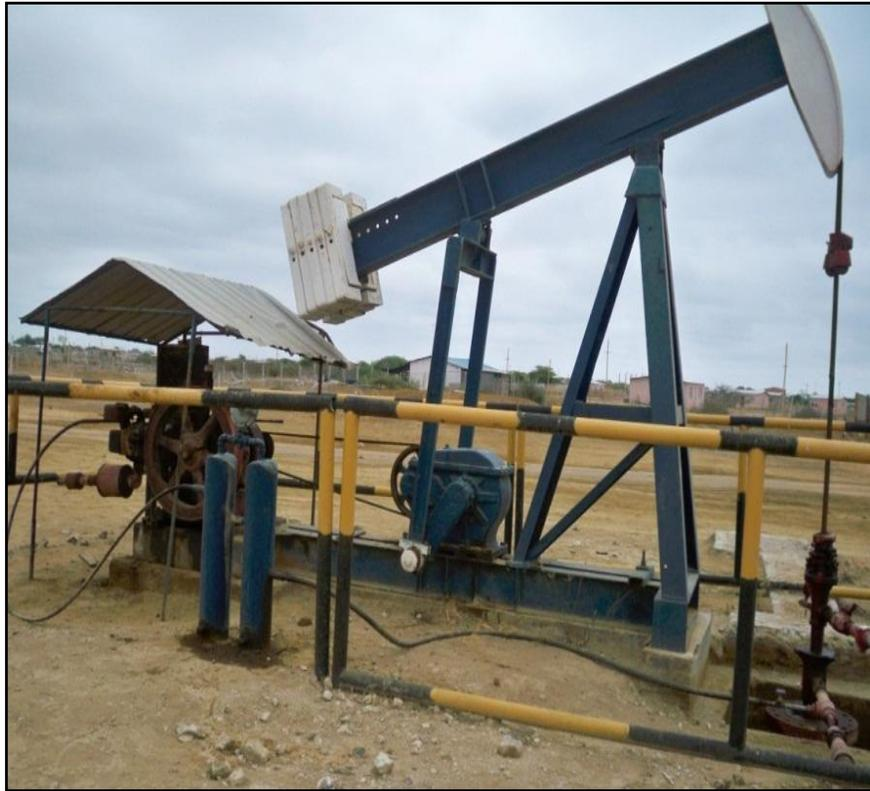
*Figura 2.4.- Equipo de superficie de Bombeo Mecánico*
