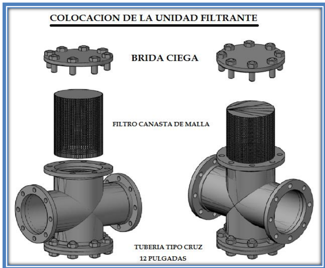
Figura 31 Colocación de la Unidad Filtrante
