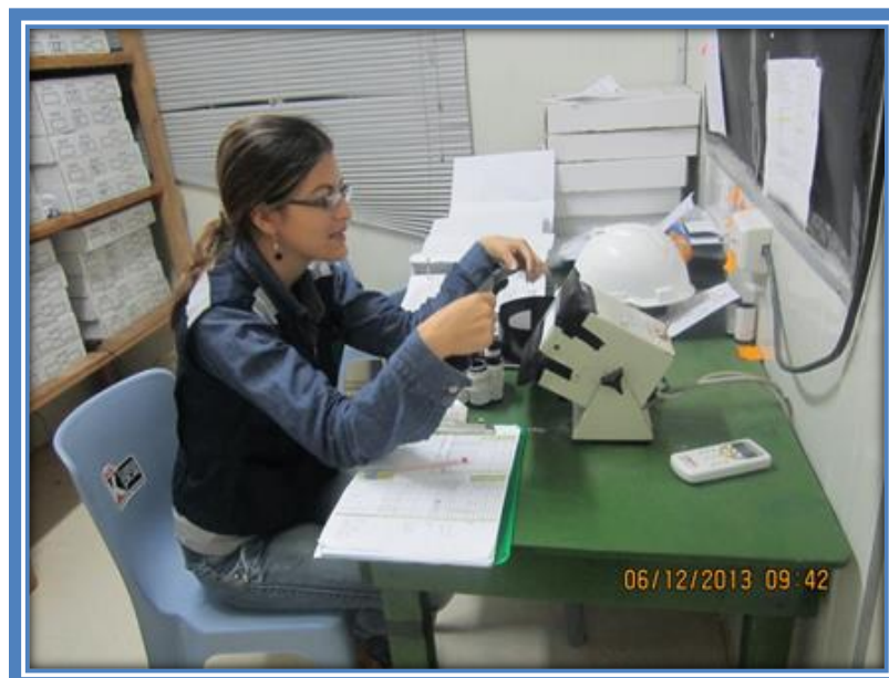
ANEXO 14. Observación de gammagrafía de soldadura en tubería
