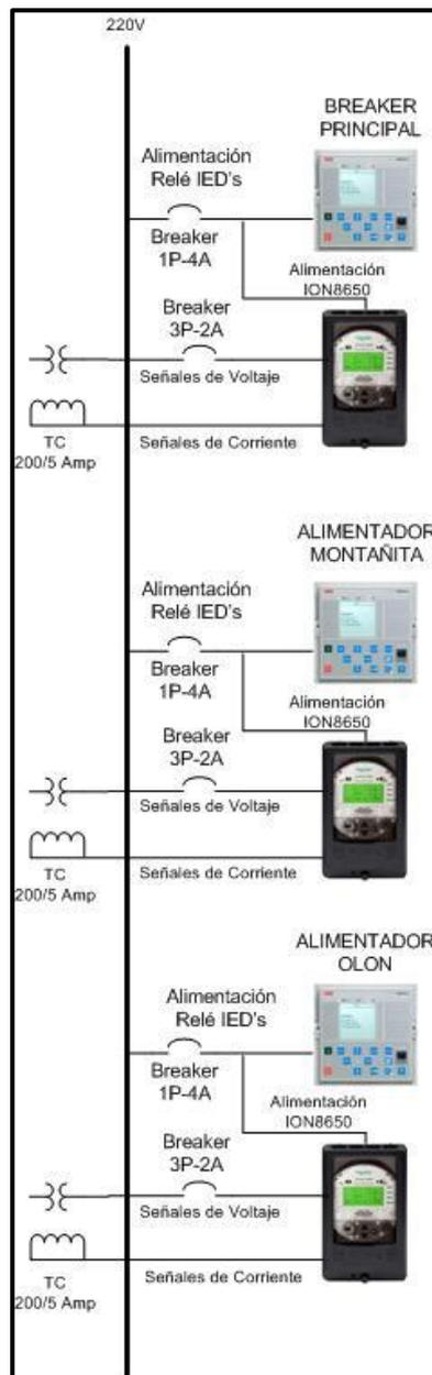
Figura 38 Diseño del sistema de señales de los equipos para la Automatización
