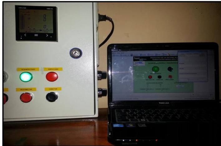
**Figura 84** Desconexión del sistema por intentos de reconexión automática
