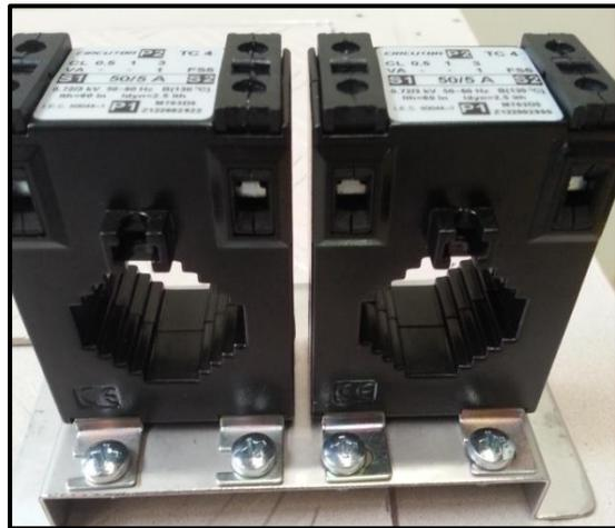
**Figura 45** Transformador de corriente 50/5A utilizados en el prototipo
