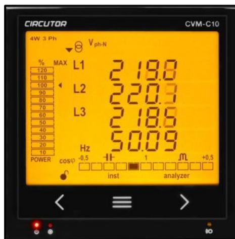
Figura 41 CVM-C10 Analizador de redes Eléctricas
