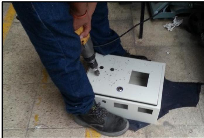
**Figura 59 Perforación de tablero para colocación de equipos**
