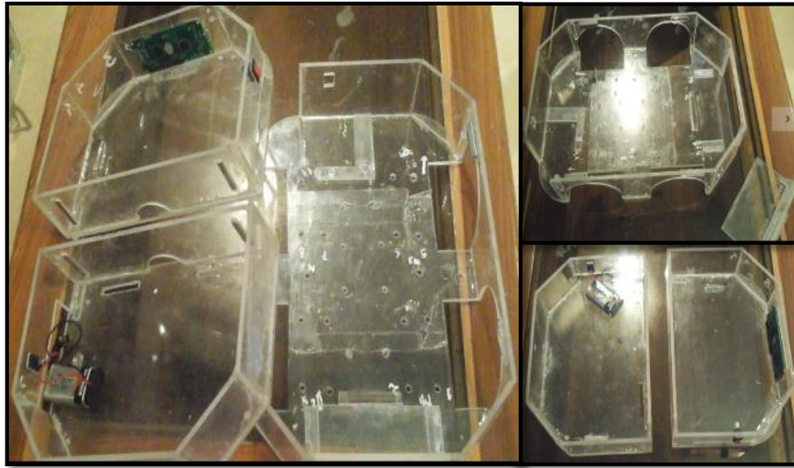
Figura 22 .Construcción de la carcasa del prototipo hecho en material acrílico transparente
