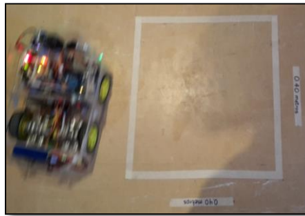
Figura 43. El robot móvil comienza a recorrer el área cuadrada de distancia 0.4mx0.4m
