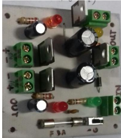
Figura 31. Conexión de circuito impreso de tarjeta reguladora de voltaje
