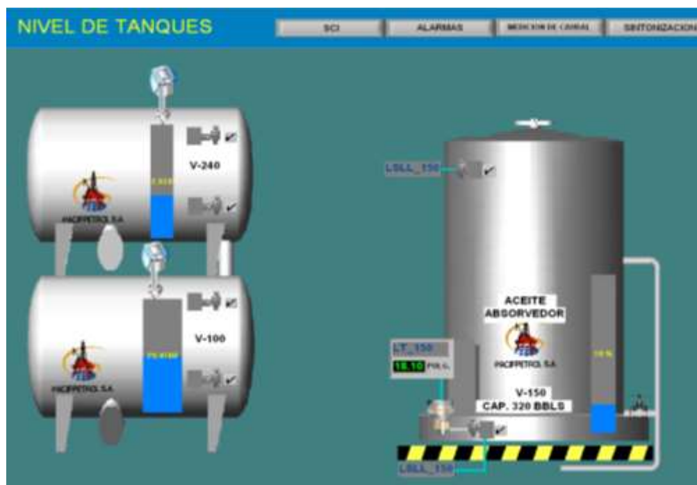
Figura 15: Ventana de Nivel de Tanques
