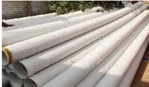
TUBERÍA PARA SISTEMA DE ALCANTARILLADO DE AGUAS SERVIDAS
