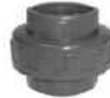
Unión universal de PVC para altas presiones de agua. Varios diámetros 1/2", 3/4", 1", 1 1/2", 2"
