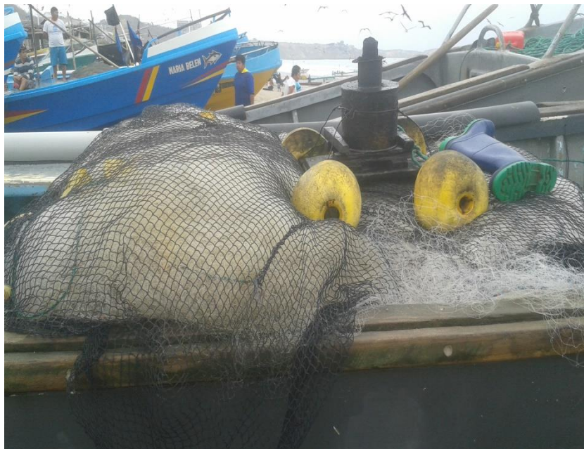
Foto 18. Red de enmalle de superficie en la embarcación pesquera (Caleta pesquera San Pedro/ 2015)
