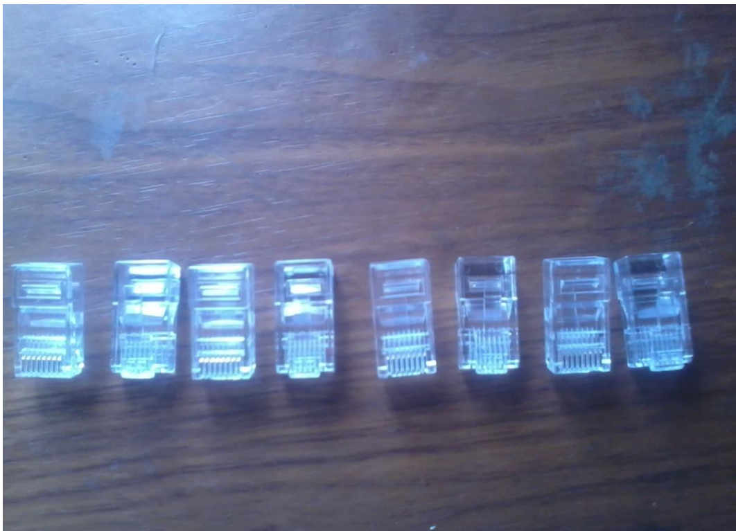
Conectores RJ45: Son muy importantes porque conecta el cable con el puerto
