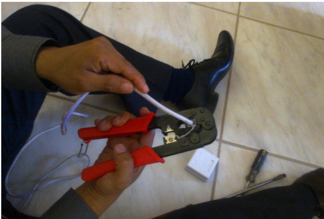
Ponchando los conectores RJ45 al cable de red
