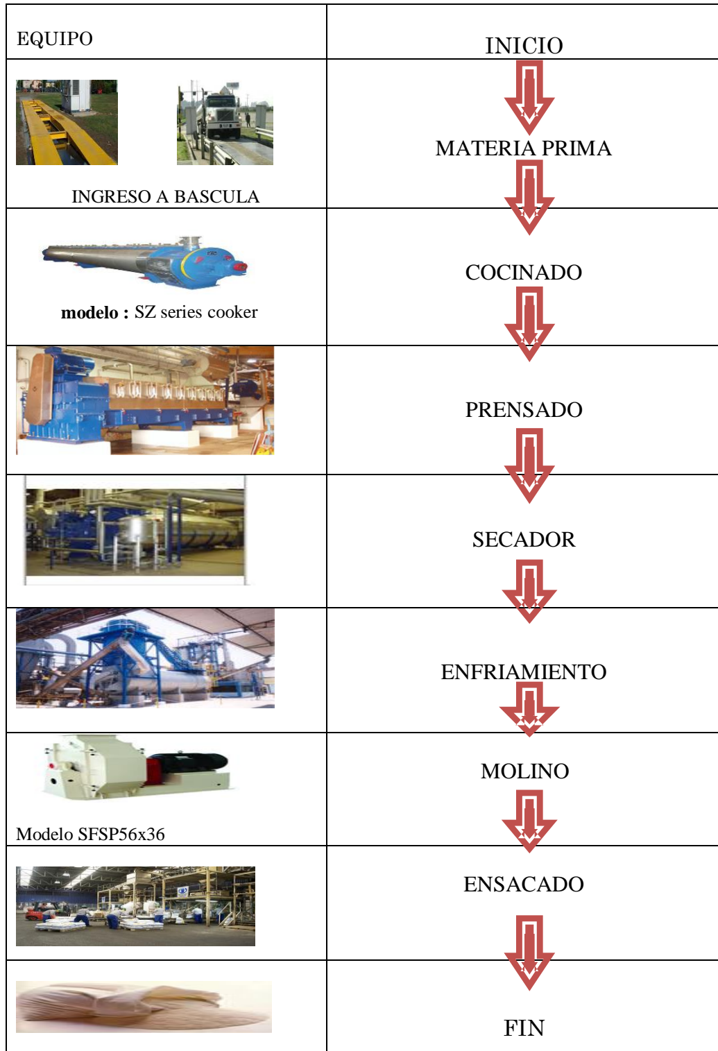
GRÁFICO N° 25 Proceso de Harina de Pescado y Equipo de la Planta
