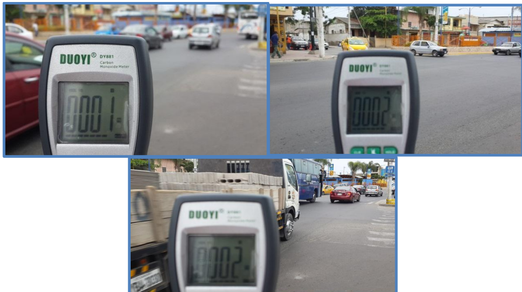
Imagen N° 47: Lecturas de monóxido de carbono. Punto # 10. Patio de comida Abdón Calderón
