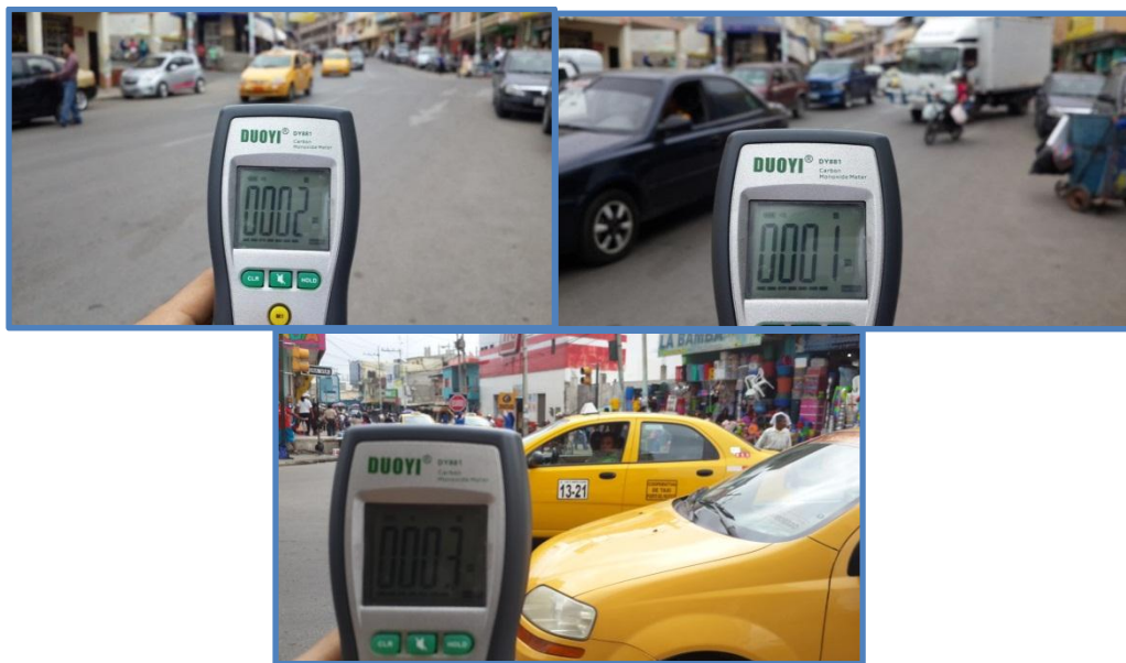
Imagen N° 44: Lecturas de monóxido de carbono. Punto # 7. Calle Guayaquil
