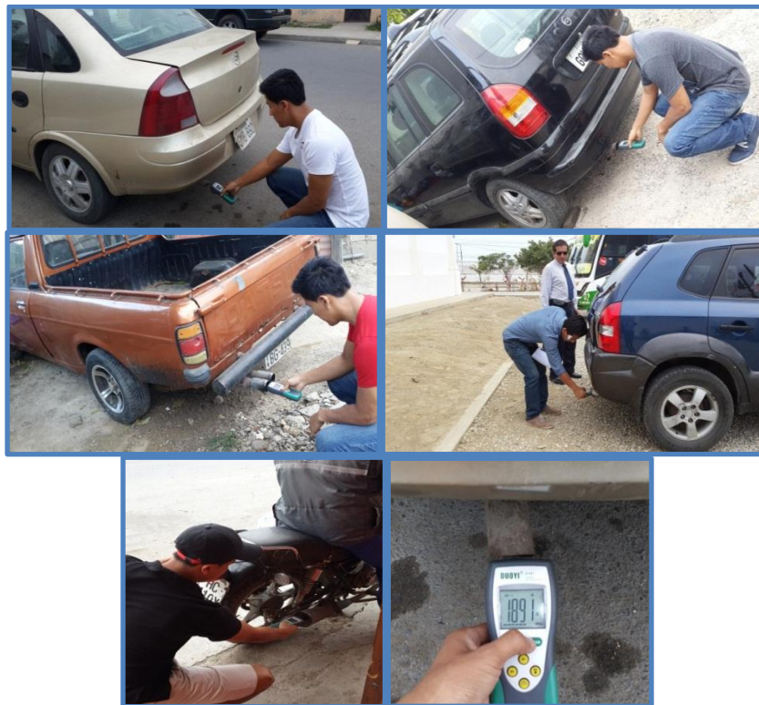
Imagen N° 33: Medición de monóxido de carbono, prueba estática.
