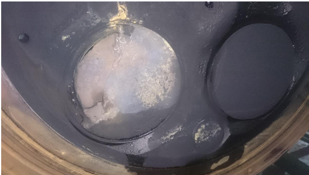
Ilustración 10 Válvula rota en cabezote
