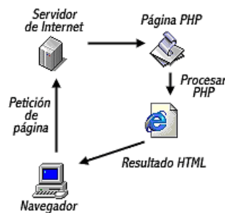
Figura 3: Esquema del funcionamiento de PHP: Tomado de: www.profesores.elo.utfsm.cl
