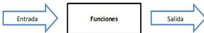
Figura 33: Técnica de caja negra
