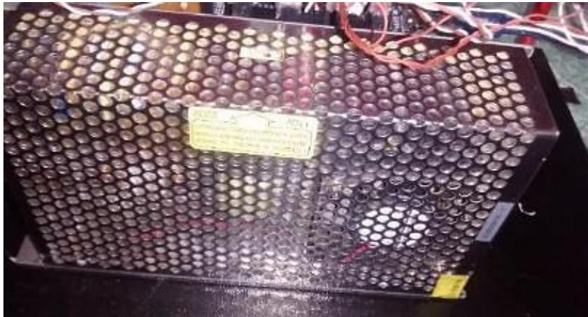
Figura 98. Fuente de Voltaje 12v.
