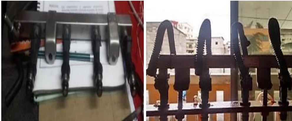
Figura 100. Montaje de Riel en los Inyectores.
