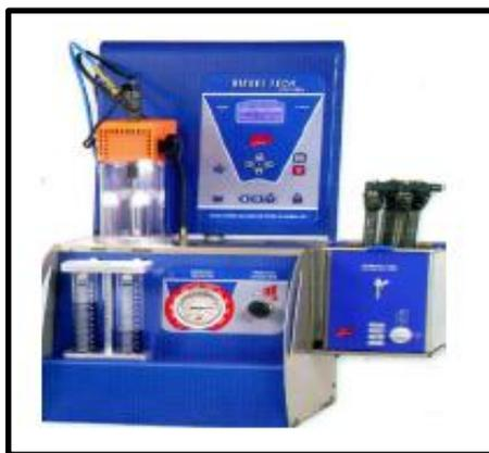
Figura 1. Comprobador de Inyectores a Diésel: Diego Lascano López.
