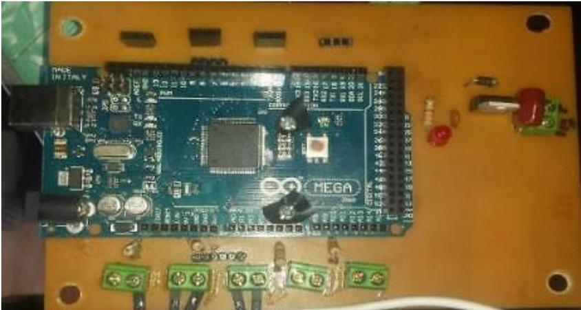
Figura 92. Demostración Circuito Panel de Mando.
