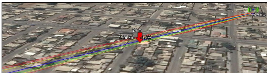
Figura 53: Ubicación de la obstrucción en el Enlace GAD-CMED sin torres Fuente: Creado por Autor, referencia: Google Earth
