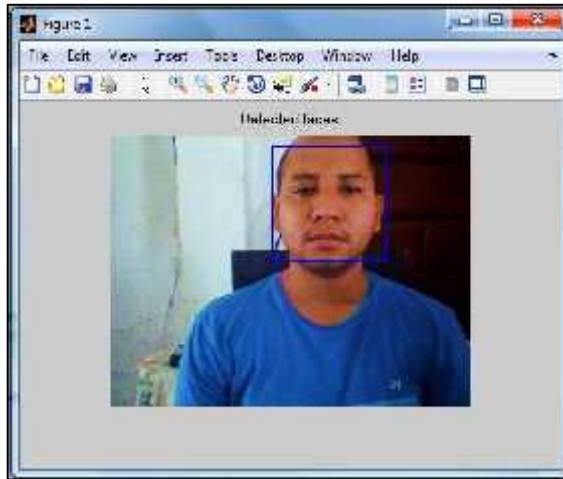
Figura 45: Aplicación del algoritmo de Viola-Jones para la detección del rostro.
