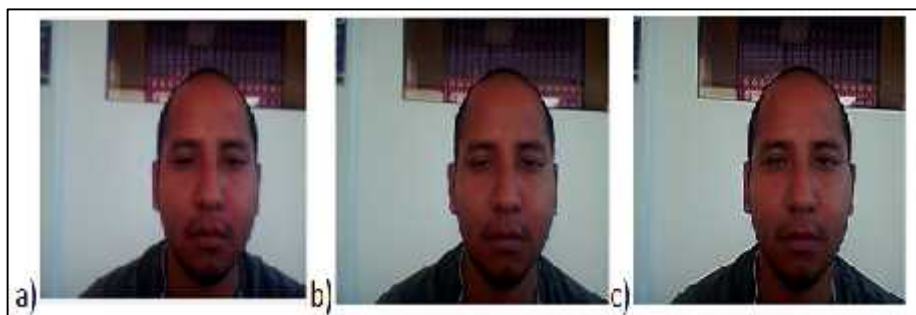
Figura 41: La nitidez muestra el grado en que la cámara adquiere una imagen detallada, a) poco definida, b) definición media, c) definición alta.
