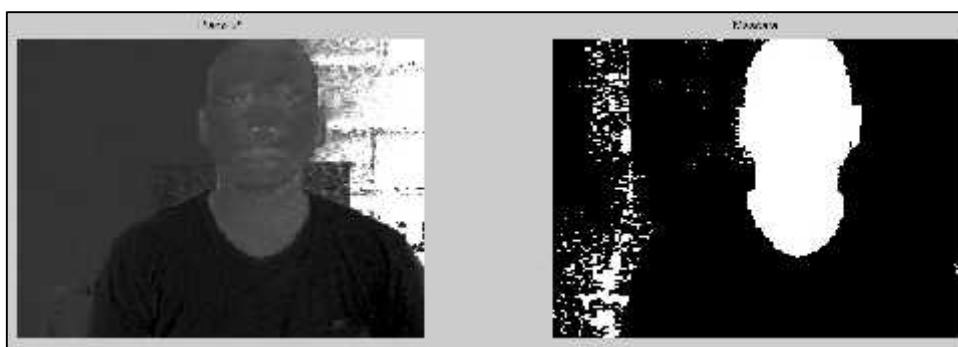
Figura 51: La imagen de la derecha pertenece al plano u^* de la trama, la imagen de la izquierda muestra la máscara con la cual se combina para filtrar la piel del rostro.
