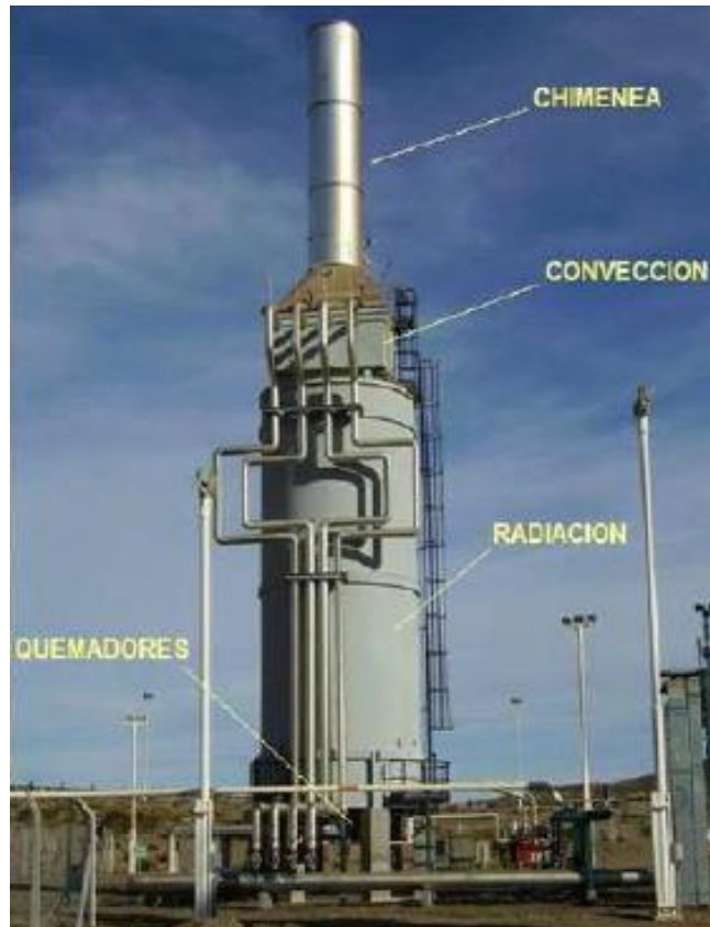
Imagen N° 4. Elementos constitutivos del Horno.
