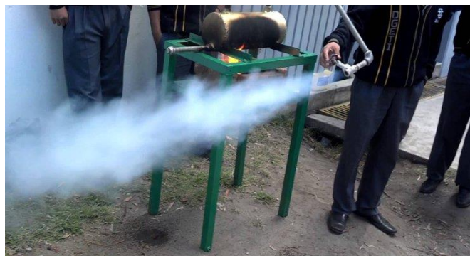
Imagen N° 14. Baja calidad del vapor producido.
