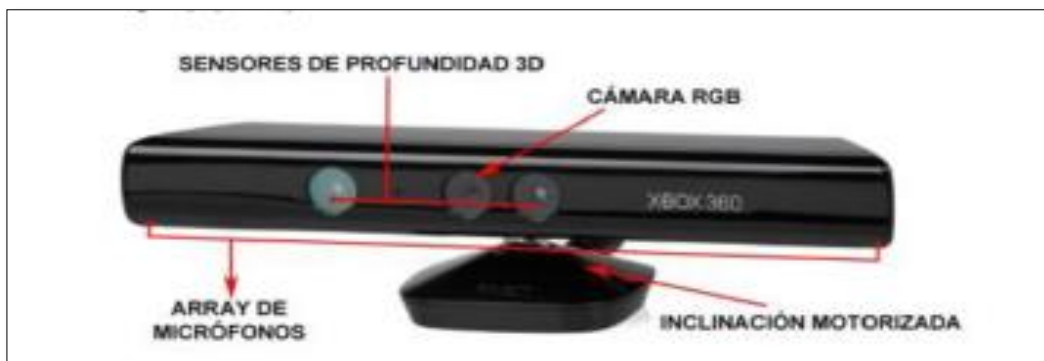
FIGURA 4 Partes del kinect [11]
